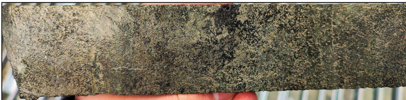
Slika 4. Fotografija jezgra sa polumasivnim pirotinom sa 498,0 m u ZRSD24165 - 5,6 g/t Au.
