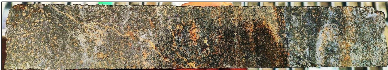
Slika 3. Fotografija jezgra bogatog piritom sa mineralizacijom zlata od 430,0 m u ZRSD24165 - 7,3 g/t Au.
